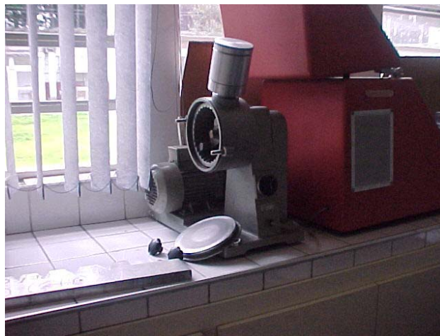
Figura 3 – Micronizador para obtenção de partícula de 12µm.
