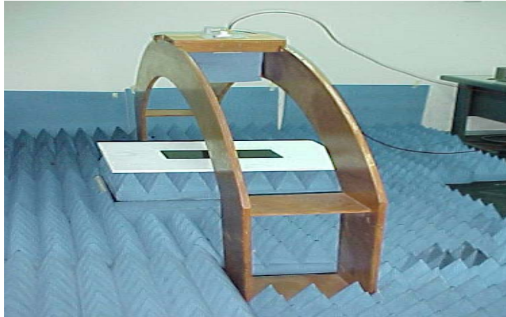
Figura 8- Interior da câmara anecóica [7].
