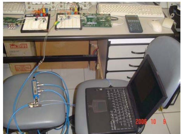
Figura 4-dispositivo ADSP-BF533/HD3-6408 integrado com a placa PASS-PCMCIA2
