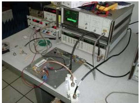
Fig. 3: Sistema de medidas para caracterização do circuito desenvolvido
