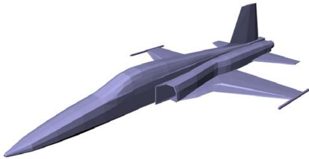
Fig.3. Representação CAD do modelo da aeronave F-5 utilizado nas simulações com o programa CADRCS. A superfície deste modelo foi discretizada em 2014 elementos triangulares.
