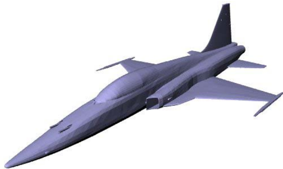
Fig.4. Representação CAD do modelo da aeronave F-5 utilizado nas simulações com o programa CADRCS. A superfície deste modelo foi discretizada em 21218 elementos triangulares.
