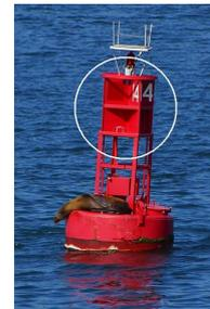
Fig. 6. Bóia de sinalização na Baía de San Diego (EUA). Observam-se os planos metálicos ortogonais próximos ao topo da estrutura [4]
