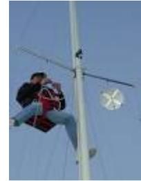
Fig. 5. *Corner reflector* instalado em mastro de embarcação
