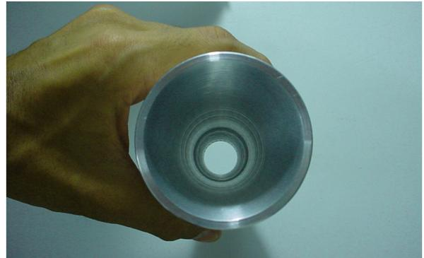
Fig. 9. Vista frontal da tubeira. (Cone divergente)
