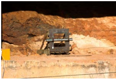
Figura 5.1 – CDP do grupo A (Tubo motor-foguete com propelente do tipo BD (M4B) com cabeça-de-guerra e tubeira não integrada ao motor. Disparo realizado à temperatura ambiente)
