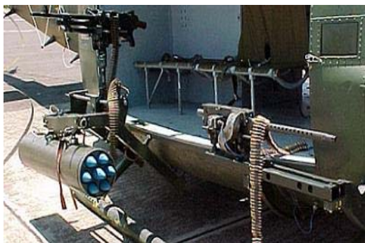
Figura 1.1- Sistema Bélico Ar-Terra 70mm, montado na aeronave de asas rotativas UH-1H.
