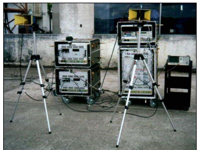
Fig. 2. Visão geral do Simulador de Ameaça TS-100+ Excalibur. O TS-100+ possui dois modos de funcionamento:
