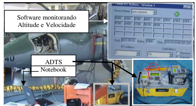
Fig. 3: A-1 com EAS (ADTS) conectado e notebook monitorando o barramento 1553B da aeronave.
