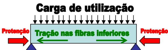
Fig.2. Equilíbrio de esforços em uma peça protendida bi-apoiada.
