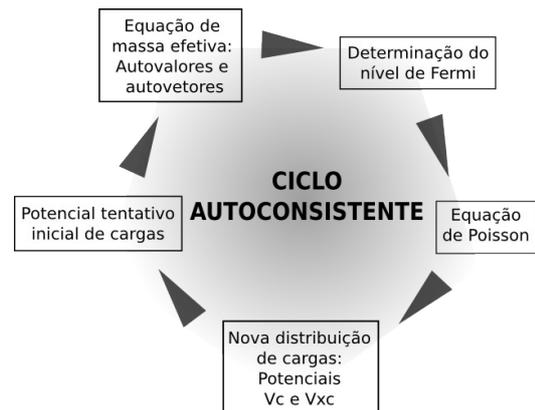
**Figura 2** – Ilustração do ciclo autoconsistente. O ciclo só é encerrado quando os potenciais determinados pela equação de Poisson são iguais aos potenciais iniciais da mesma iteração. Quando convergido, os autoestados e autoenergias do sistema são determinados.
