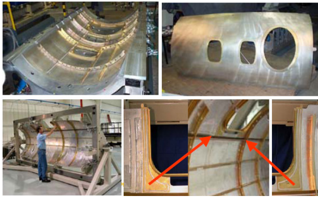
Fig. 8 – MONTAGEM DOS REVESTIMENTOS DE CABINE FEITOS POR FSW [11].
