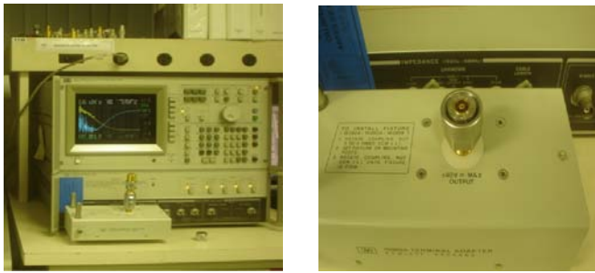
Fig. 2. (a) analisador de impedância e fase HP, mod. 4194A. (b) porta amostras HP, mod.1608.
