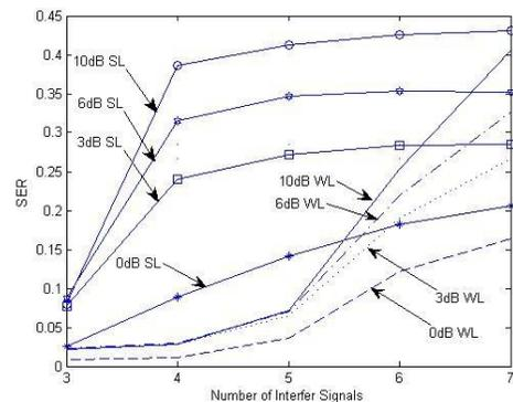
Fig. 4. SER usando os algoritmos LMS-SL e LMS-WL
