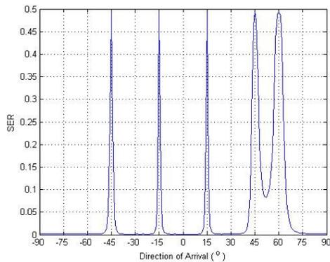
Fig. 6. SER usando o algoritmo FROST-WL para 5 interferentes
