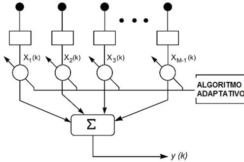
Fig. 1. Arranjo de antenas adaptativas e diagrama de irradiação ilustrativo.
