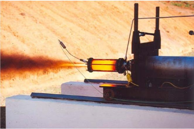
Fig. 12. Teste de estado-reator utilizando polietileno como combustível
