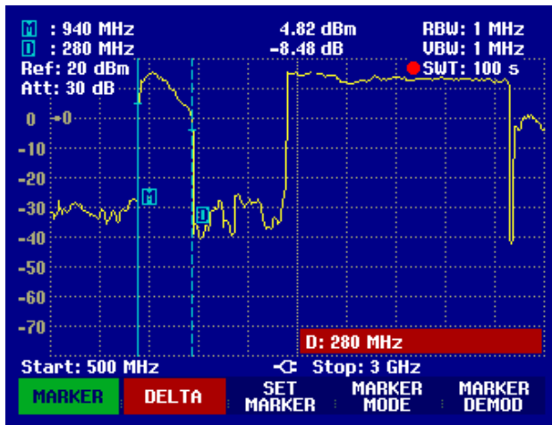
Fig. 5. Espectro de saída armazenado do protótipo#1 de divisor-por-2 de frequência paramétrico balanceado, para um sinal de entrada com 8 dBm variando de 1700 MHz to 2800 MHz.
