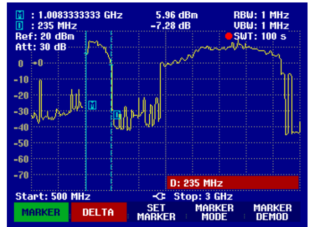
Fig. 7. Espectro de saída armazenado do protótipo#2 de divisor-por-2 de frequência paramétrico balanceado, para um sinal de entrada com 8 dBm variando de 1700 MHz to 2800 MHz.
