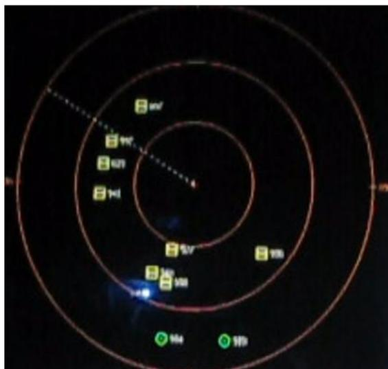
Fig. 8: Neste cenário há 6 radares de navegação: três na faixa de 3 GHz em 195°, 280° e 325° e três na faixa de 9 GHz sendo dois em 195° e um em 285°. Nesta figura, a proximidade ao centro da tela é proporcional à letalidade. No círculo central são colocados emissores hostis, no médio os desconhecidos e no externo os amigos.
