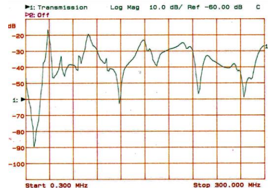
Fig. 4. Gráfico da resposta do “fator de antena” da antena de laço com N = 7 em função da frequência na faixa 300 kHz-300 MHz.
