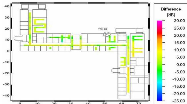
Fig. 7. Diferença entre medições e predição pelo Modelo do Caminho Dominante, com o transmissor nas posições 8 (direita).
