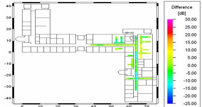
Fig. 8. Diferença entre medições e predição pelo Modelo do Caminho Dominante, com o transmissor na posição 2 (direita).
