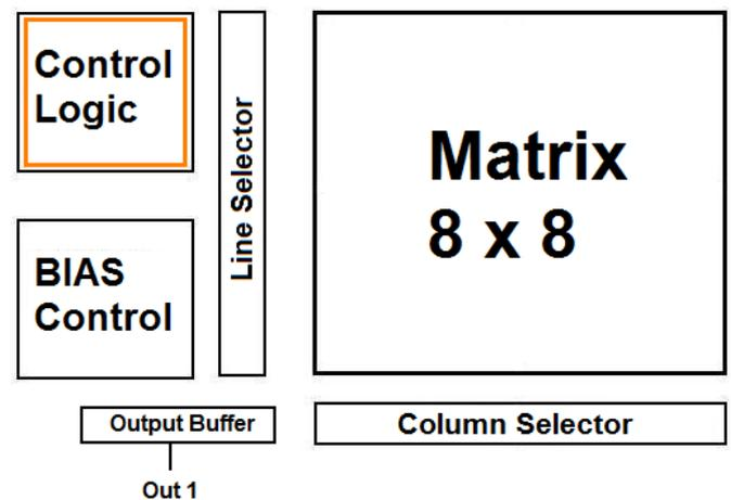
Fig. 1. ROIC Block diagram.
