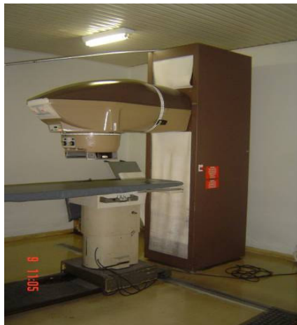
Fig. 3. Fonte de radiação gama de ^{60}\text{Co} do Laboratório de Radiação Ionizante (LRI) do Instituto de Estudos Avançados (IEAv)
