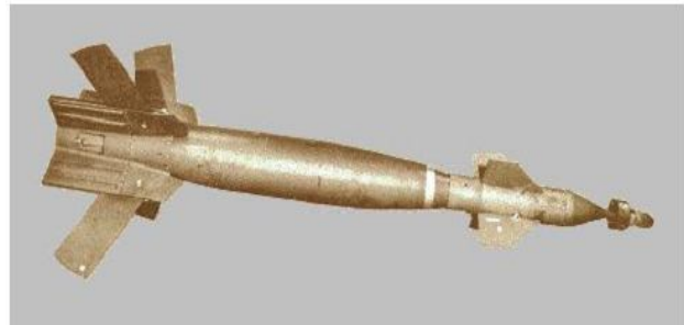
Fig. 1 – Módulo Paveway II equipando Mk-83 [16].
