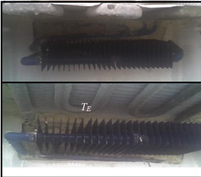
Fig. 3. Interior da geladeira a gás GLP, onde: T_E - Temperatura do refrigerante no evaporador.
