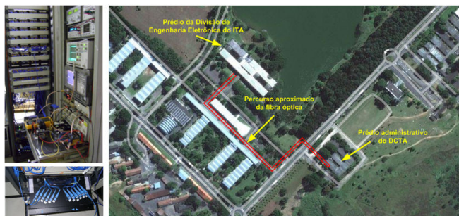
Fig. 12: Demonstração de conceito da transmissão de sinais radar em uma rede de fibra externa. À esquerda: distribuidor de fibra óptica da rede e arranjo experimental do EAFO e do emissor radar pulsado. À direita: percurso de fibra óptica da rede de fibra óptica do DCTA usado para demonstração.
