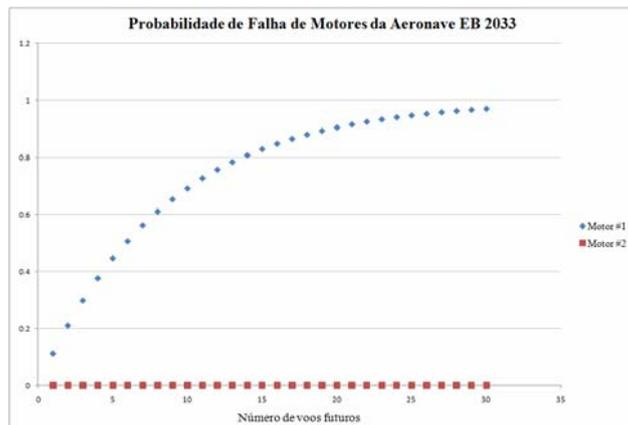
Fig. 10. Probabilidade de Falha de Motores da Aeronave EB 2033.
