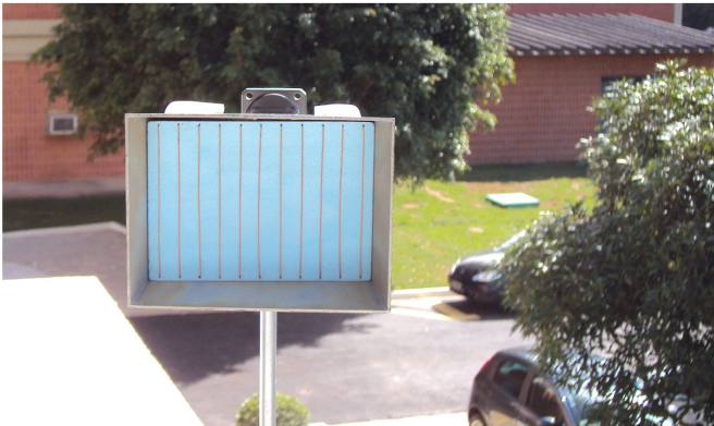
Fig. 6. Antena carregada com o arranjo periódico de fios metálicos.
