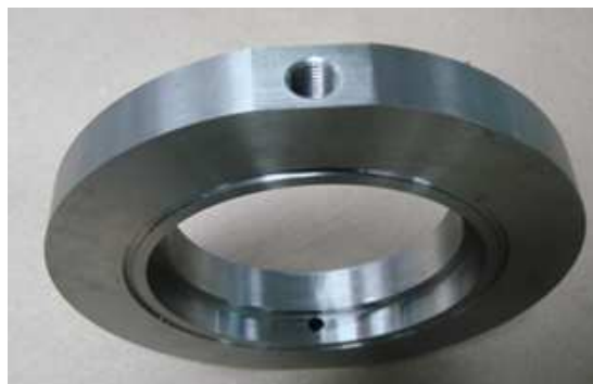
Fig. 3. Vista lateral do injetor rotacional sem os conectores e mangueiras.
