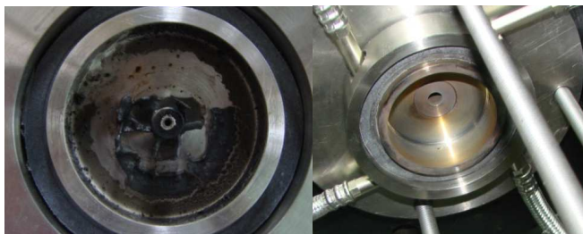
Fig. 12. Comparação entre a seção transversal da saída do injetor após os testes, axial (esquerda), rotacional (direita).
