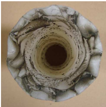
Fig. 8. Padrão helicoidal de consumo, vista superior do grão após ensaio com injetor rotacional B.
