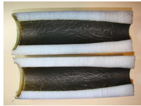
Fig. 4. Vista lateral do grão após ensaio com injetor axial.
