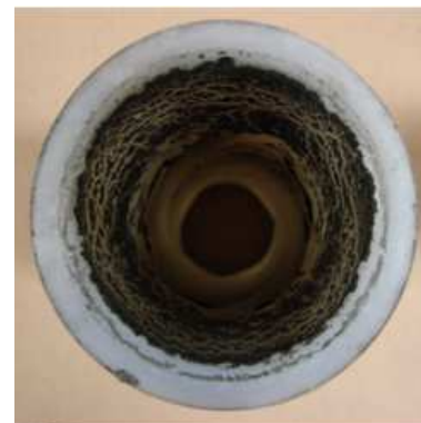
Fig. 6. Vista superior do grão após ensaio com injetor rotacional A.
