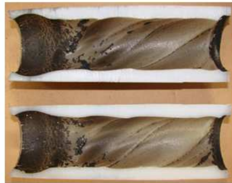
Fig. 5. Vista lateral do grão após ensaio com injetor rotacional A.
