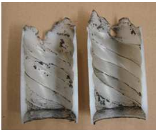
Fig. 7. Vista lateral do grão após ensaio com injetor rotacional B.
