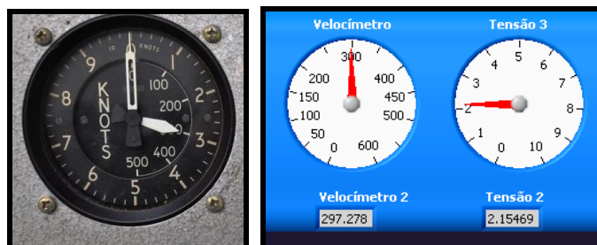
Fig. 4: velocímetro real e instrumentos virtuais do AqGeraDado.
