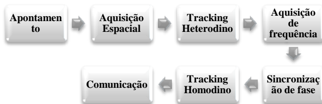
Fig. 3– Sequência PAT para estabelecimento de comunicações ópticas. [2]
