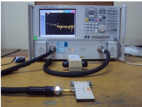
Fig. 3. Set-up utilizado na caracterização das contas de ferrita [3].
