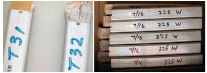
Fig. 2. Cartuchos de Flares MTV, modelo M-206, após sofrerem expansão volumétrica em função do processo de envelhecimento acelerado [18].
