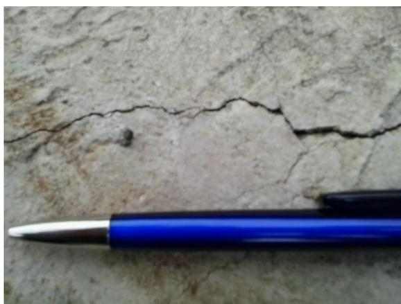
Fig. 4. Fissuras geradas na laje de concreto na explosão a 3,0 m da laje.
