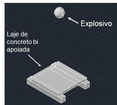
Fig. 1. Dispositivo para o ensaio experimental.
