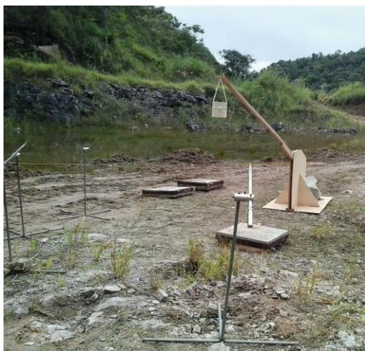
Fig. 2. Medidores de pressão posicionados em volta da carga explosiva. O braço de madeira suspende a carga explosiva na altura determinada para o ensaio acima da placa de concreto.
