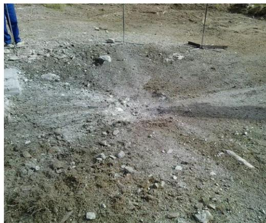
Fig. 3. Resultado da explosão do PBX posicionado sobre a laje de concreto.
