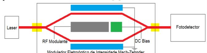
Fig. 1. Diagrama esquemático do Enlace Analógico a Fibra Óptica (EAFO) com modulador de intensidade e detecção direta (IMDD).
