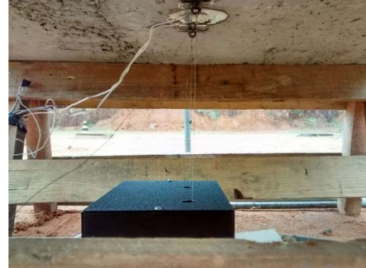
Fig. 1. Caixa metálica protegendo o transdutor de deslocamento posicionada sob a laje.
