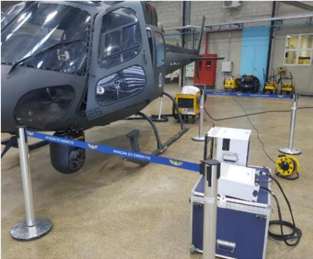
Fig. 1. Configuração montada para as medições. A foto apresenta um helicóptero com FLIR instalado visualizando um Corpo Negro.
