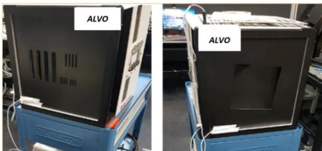
Fig.2. Alvos utilizados para aquisição das imagens (padrão 4 Barras a esquerda e quadrado vazado a direita), com um termopar acoplado à base dos mesmos.
