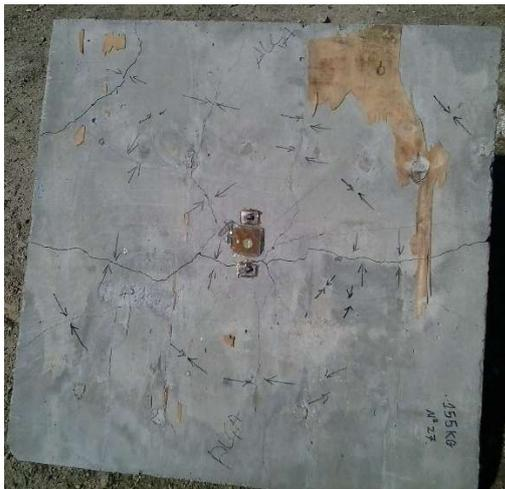
Fig. 8. Face inferior da laje 2. Trincas podem ser observadas, porém a peça não foi seccionada.
