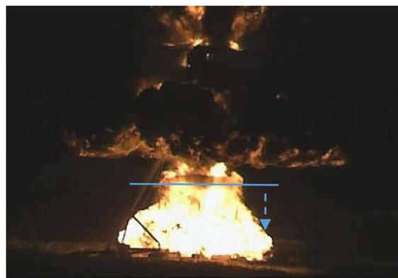
Fig. 7. Registro de frente de onda refletida se deslocando contra a laje 2 na sequência da imagem da Fig. 5. Imagem obtida a 3,3 ms do disparo da espoleta.
