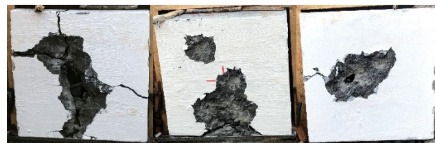
Fig. 5. Placas SF02, CF02- e CF02+ atingidas pelo Fuzil 5,56.
