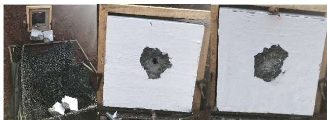
Fig. 4. Placas SF01, CF01- e CF01+ atingidas pelo Fuzil 7,62.
