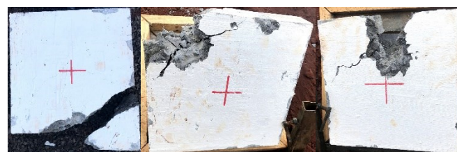
Fig. 6. Placas SF03, CF03- e CF03+ atingidas pela Espingarda.
