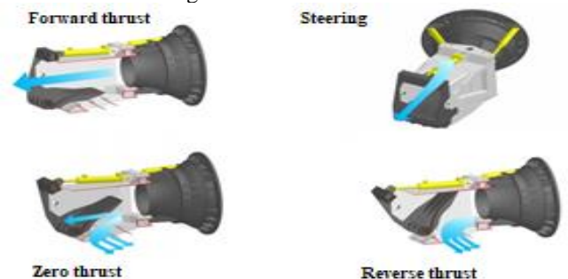
Fig. 4. Mecanismo do controle de empuxo do hidrojato.
