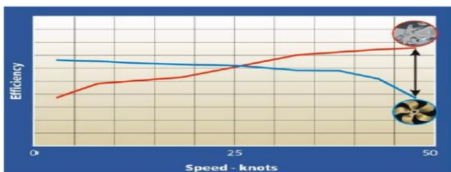
Fig. 6. Eficiência de hidrojatos e propulsores convencionais [18].
