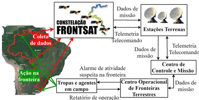
Fig. 4. Arquitetura operacional do sistema FrontSat.
