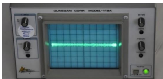
Fig. 7 – Sinal obtido no osciloscópio no Teste de PIND
