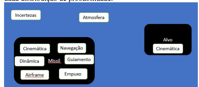
Fig. 1 Elementos do modelo de simulação do míssil MANPADS. [Autor]
