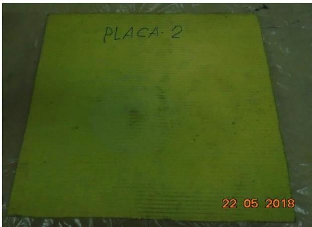
Figura 8 – Placa 2 após o ensaio balístico – vista traseira.
