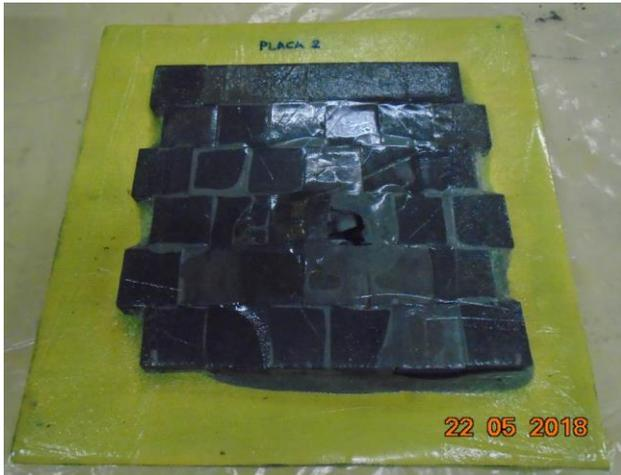
Figura 7 – Placa 2 após o ensaio balístico – vista frontal.
