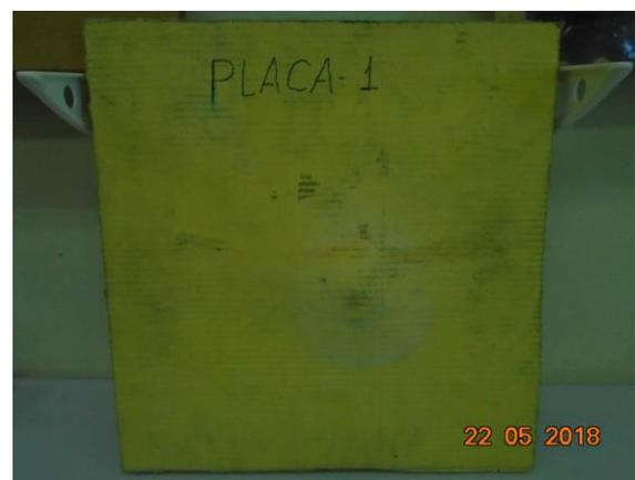
Figura 6 – Placa 1 após o ensaio balístico – vista traseira.
