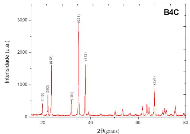
Figura 2: Espectro de difração de raios X do pó de carбето de boro.
