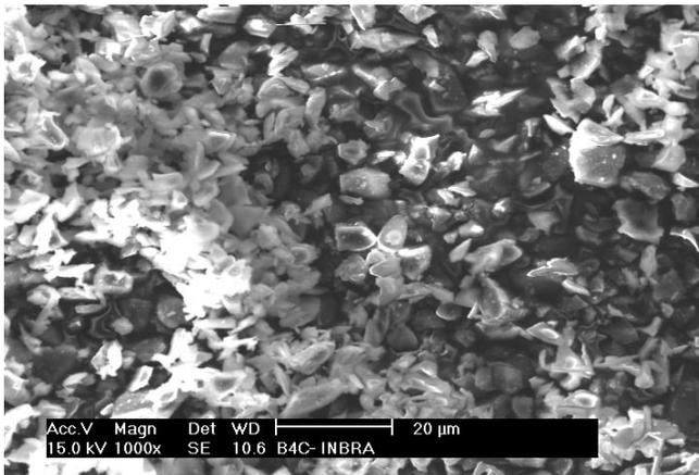
Figura 4: Microscopia Eletrônica de Varredura do pó de  $B_4C$  com um aumento de 1000x.
