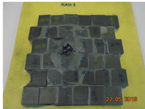
Figura 5 – Placa 1 após o ensaio balístico – vista frontal.
