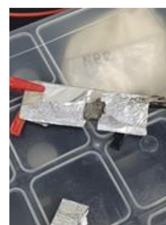
Amostra de BaSRCoMnTiFeO no ensaio de resistividade
