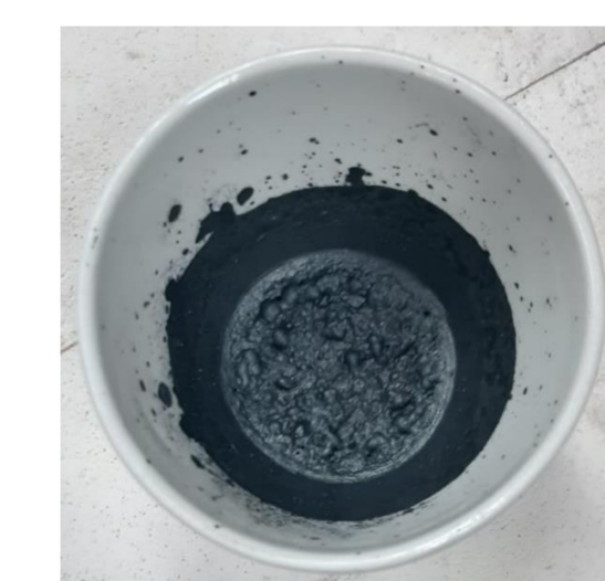
Amostra final da solução NiZnCuFeO
