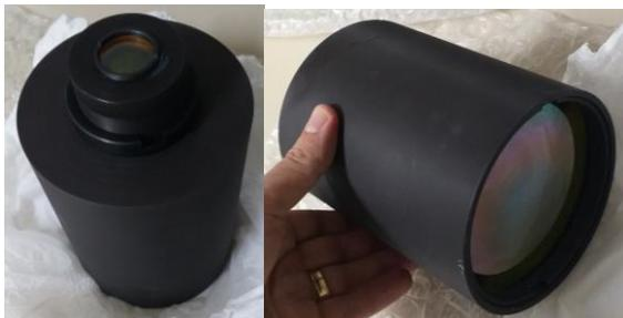
Fig. 3. Conjunto óptico com duas lentes côncavo-convexas.
