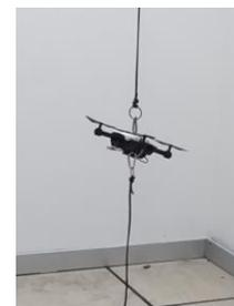
Fig. 1. Drone preso para manter a mobilidade reduzida durante o voo.
