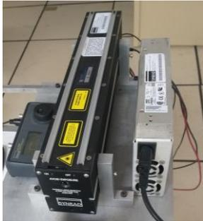
Fig. 2. Laser de CO<sub>2</sub> da marca Synrad, de 30 W, com potência ajustável.
