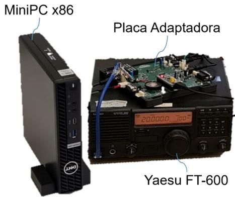
Fig. 1. Plataforma TID-HF com Rádio Yaesu FT-600, expondo placa adaptadora para rádios legados
