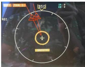
Fig. 13: Identificação do trigrama correspondente as ameaças CW2 e P01 do teste de detecção simultânea (um sinal pulsado junto a um sinal contínuo).
