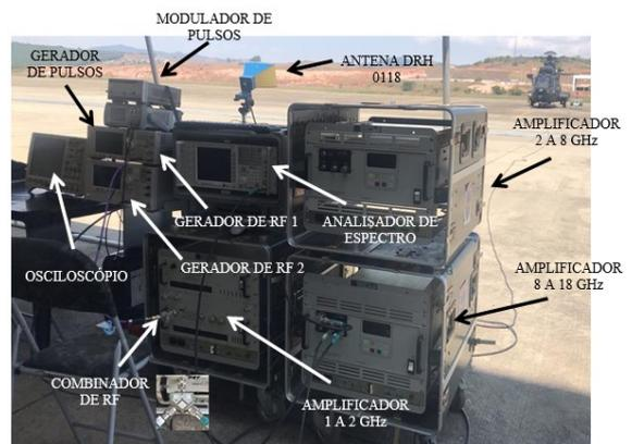
Fig 6.: Implementação do Simulador Radar.
