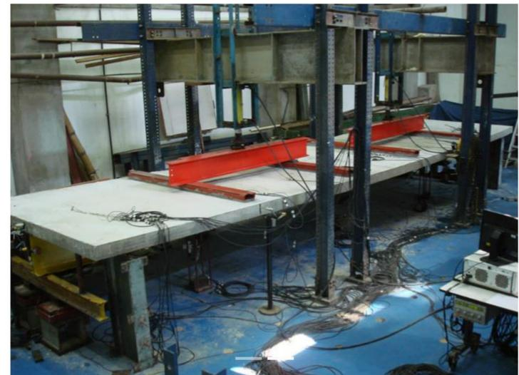
Fig. 8. Ensaio de resistência à fadiga. (Fonte: lem.civ.puc-rio.br).
