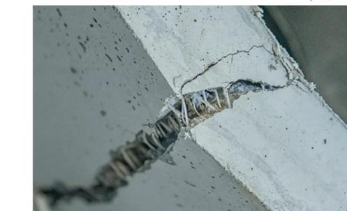
Fig. 6. Fibras sintéticas retardando o crescimento de fissura do concreto. (Fonte: arkitecture.org).
