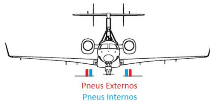
Fig. 5. Posição dos pneus em relação ao trem de pouso principal.
