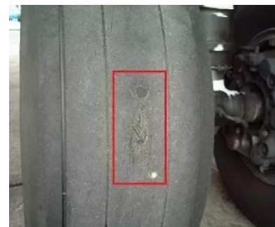
Fig. 3 - Primeira camada de lona exposta.
