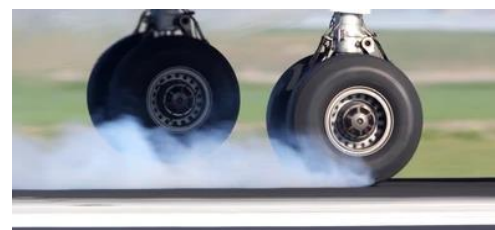
Fig. 2. Fumaça provocada pelo toque do pneu com a pista.
