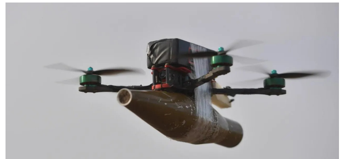
Fig. 1: Drone caseiro adaptado com bateria de maior capacidade e carga explosiva improvisada fixada com fita adesiva.
