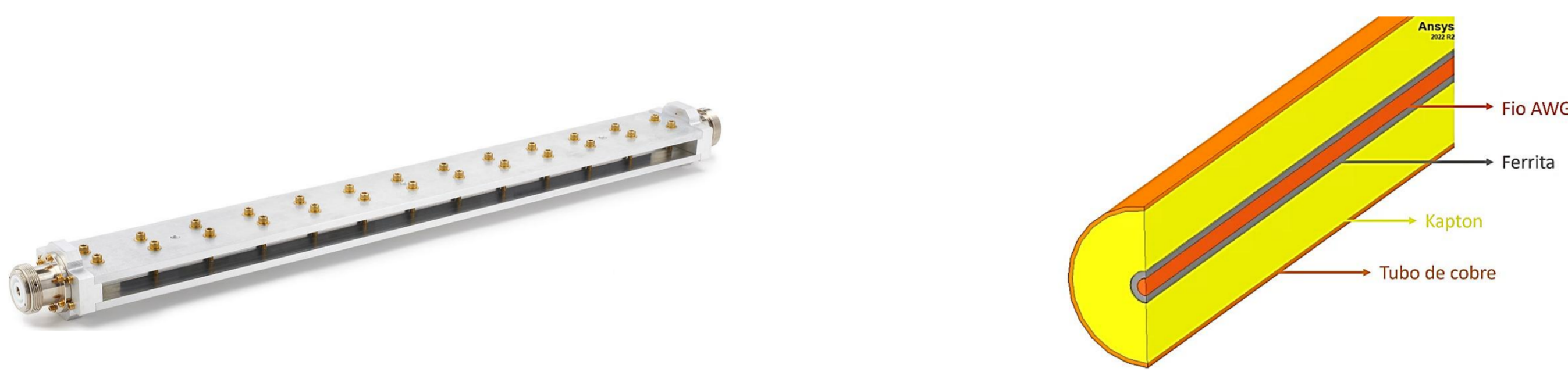
Fig. 1. LTNLG comercial produzida pela empresa Metamagnetics com placas paralelas.
